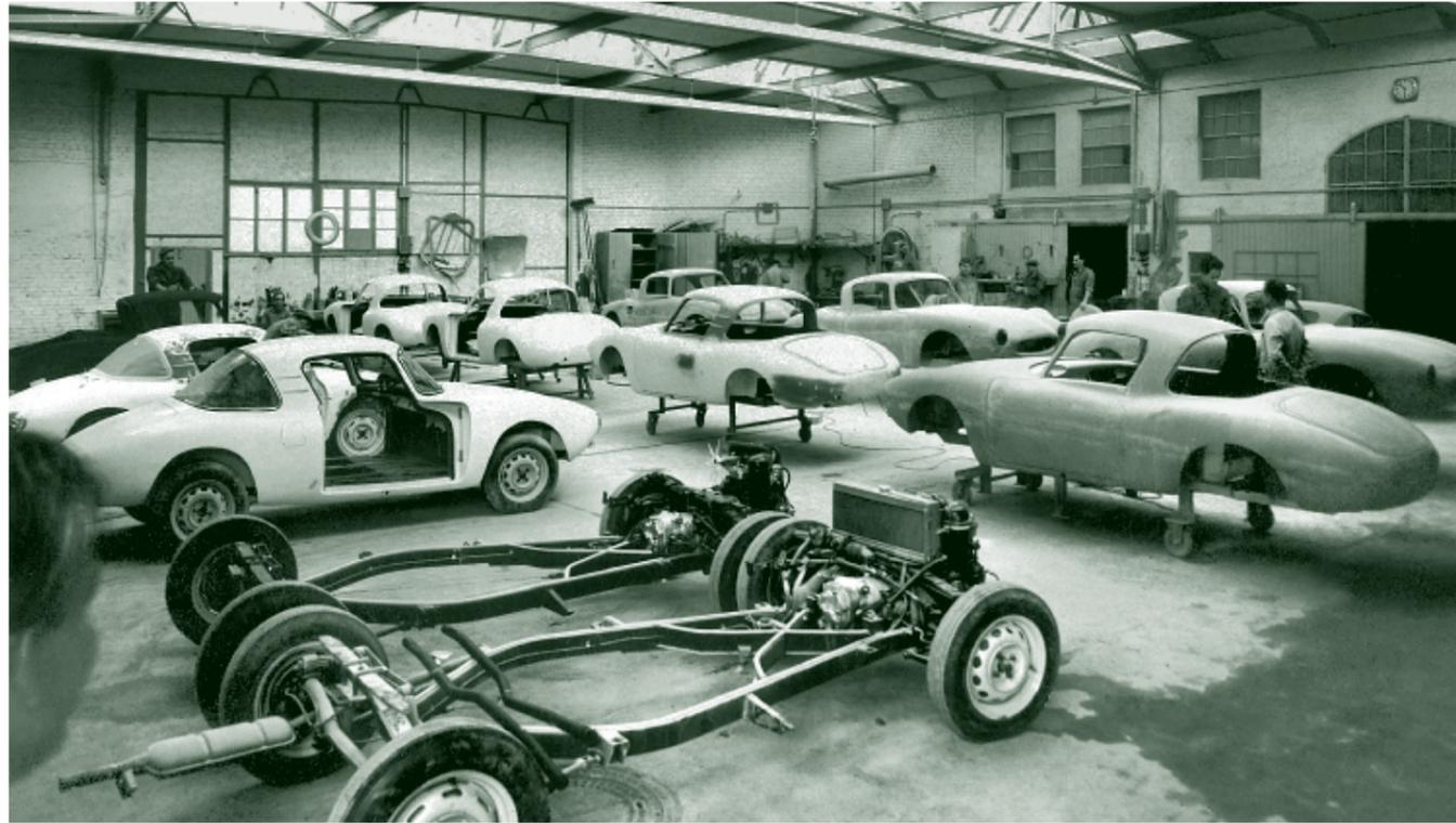
Abb. Blick in die Montagehalle des 3=6 Monza bei Schenk in Stuttgart 1958. Im Vordergrund zwei von der Auto Union in Düsseldorf angelieferte Fahrgestelle.
